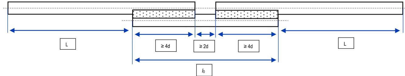
Figure 1 — Assemblage à recouvrement
