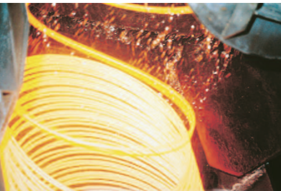
Laminage à chaud du fil machine.
