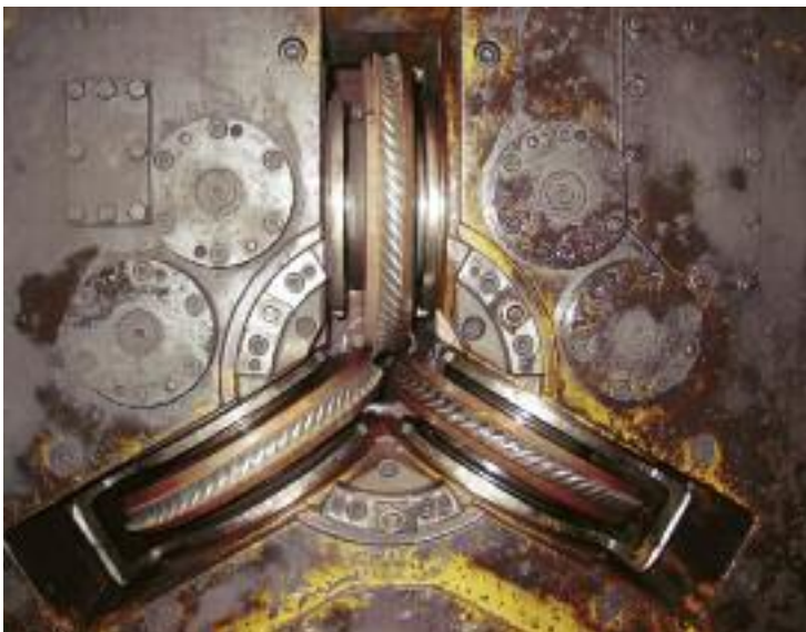
Cage de laminage à chaud avec 3 galets de crantage pour la réalisation de verrous.
