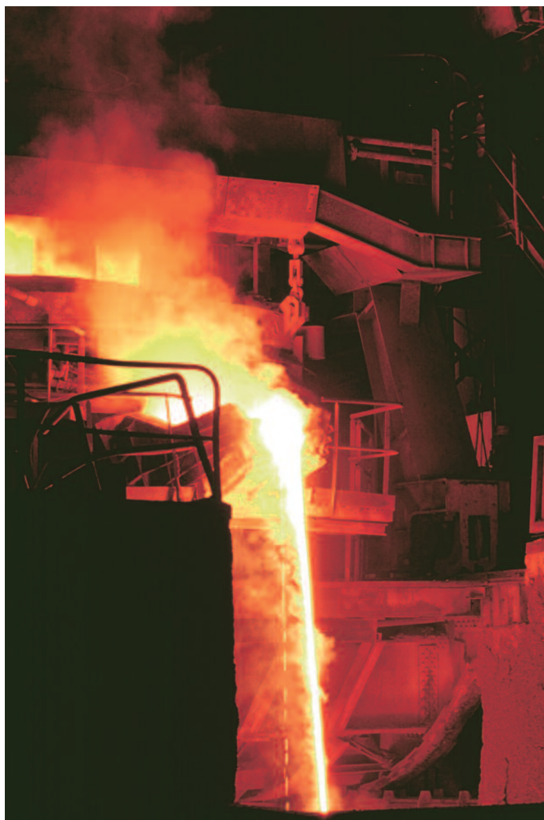
Coulée du métal liquide.
